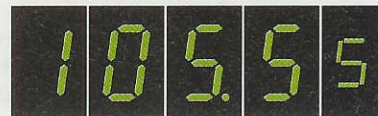
Fig.27 Per le frequenze maggiori di 100 MHz, vedrete apparire le tre cifre dei MHz e le due cifre delle centinaia e decine di KHz.
