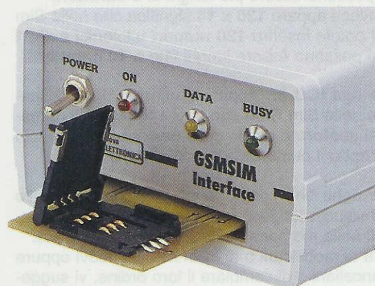
Fig.1 Tutti i numeri telefonici di un cellulare risultano memorizzati nella piccola scheda Sim Card. Inserendo questa scheda nel nostro circuito, potete vedere sul monitor del computer tutti i numeri memorizzati, inserirne dei nuovi, correggere gli errori, ecc. Assieme al kit vi verrà fornito un floppy contenente il software GSMSIM.
